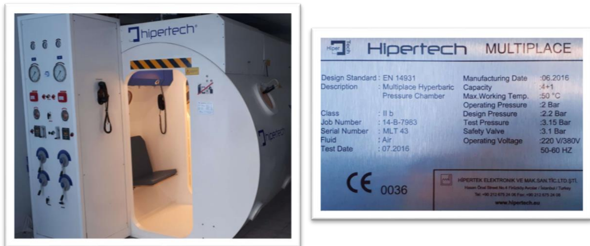
Фиг. 1 Хипербарен комплекс, гр. Варна. Вляво е хипербарната камера, а вдясно на фигурата е представен списък на техническите параметри.
