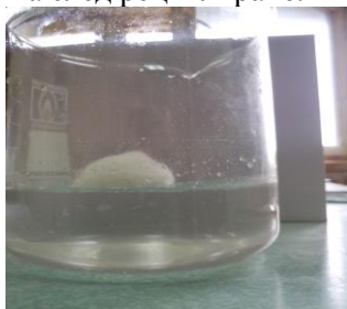
Фиг. 24. Рециклиран образец силициев аерогел, потопен във вода
