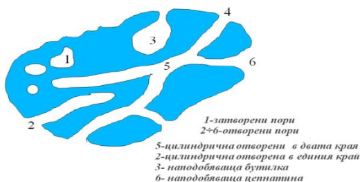
Фигура 20. Схематично представяне на напречно сечение на пореста частица
