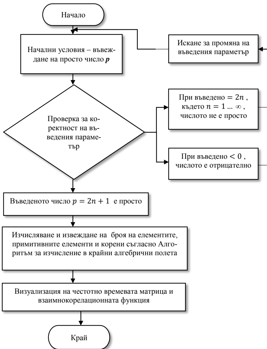
Фиг. 4.2. Блок схема на Алгоритъм за визуализация на честотно-времевата матрица (ЧВМ) и взаимнокорелационна функция (ВКФ)
